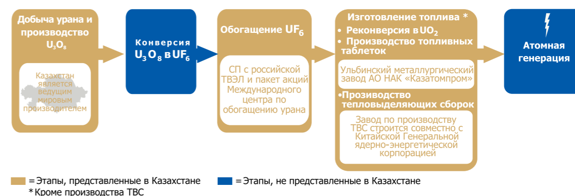
Рис. 7.7. Этапы входной фазы ядерного топливного цикла
