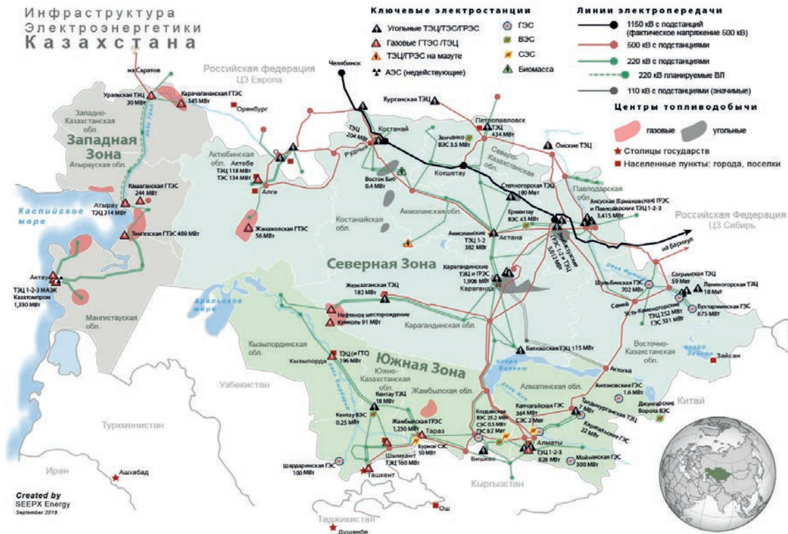
Рисунок 5.1 – Инфраструктура электроэнергетики Казахстана.
