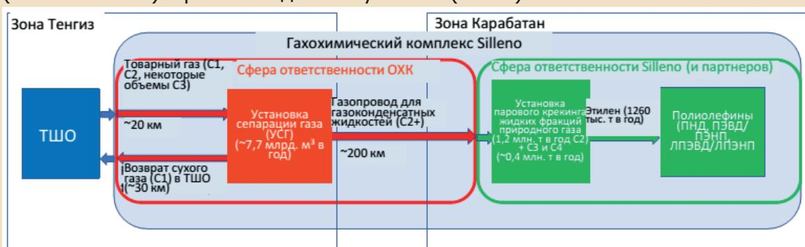
Рис. 4.7. Схема газохимического комплекса ОХК
