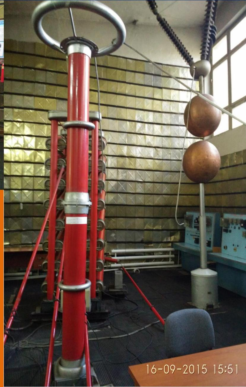
1) установка по генерированию постоянного тока напряжением 300 кВ
